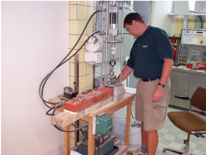
Bild D. Visar hur stenarna kan utsättas för dragkrafter i dragpressen, sedan tegelbalken är fäst mot bordet. Lägsta värdet visar att det behövs ca: 150 kp dragkraft för att dra loss en sten, i detta prov.
