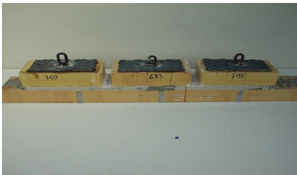
TRE STENAR SPRUTFOGADE TILL EN TEGELBALK
